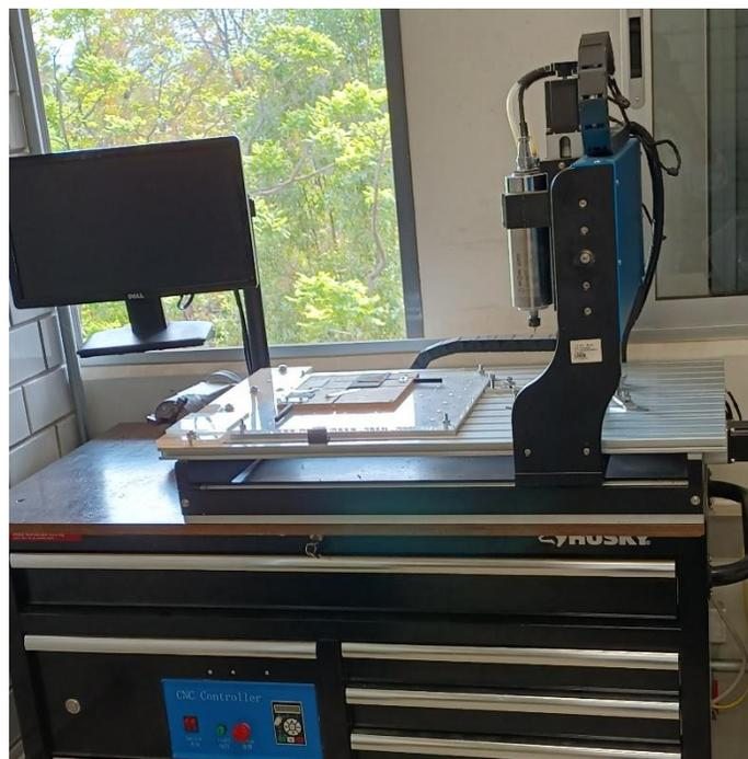
Figura 1. Fresadora CNC
