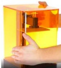
Figura 2.6. Instalación de cubierta UV
