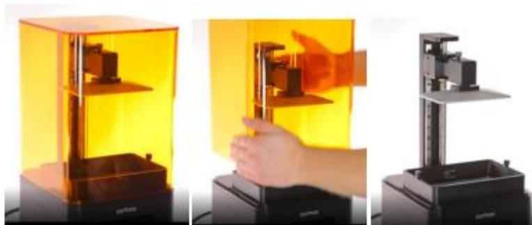
Figura 3.1. retiro de cubierta UV.
