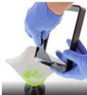
9.1 Limpia el tanque de resina con una toalla de papel. También puede usar alcohol isopropílico al 99 % para ese propósito. Si cambia el color o el tipo de resina, limpie el tanque en el limpiador ultrasónico
