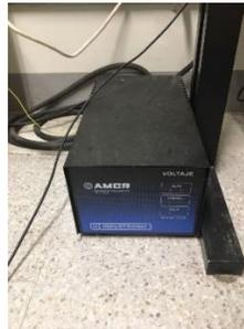
5. Encender interruptor que se encuentra en la parte trasera del regulador, se escucharán los contactores enclavarse indicando que el regulador está en marcha. Verifique que las luces indicadoras enciendan en la sección normal, si es alto o bajo, verifique que su toma de corriente este en buen estado.
