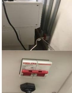
7. Dirigirse a panel de encendido de CNC Láser, y presionar el botón de encendido general y encender el láser.
