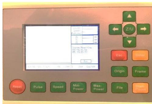
Figura 1.9 Panel de posicionamiento de cabezal
