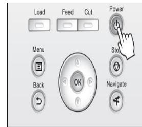
Figura 3.1. Modo de apagar la impresora.
