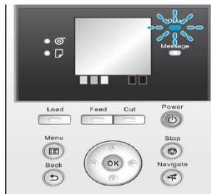
Figura 3.0. LED que indica que hay un trabajo en proceso.
