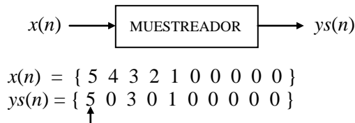
Figura 7.5 Sistema MUESTREADOR con sus secuencias de entrada x(n) y salida ys(n)
