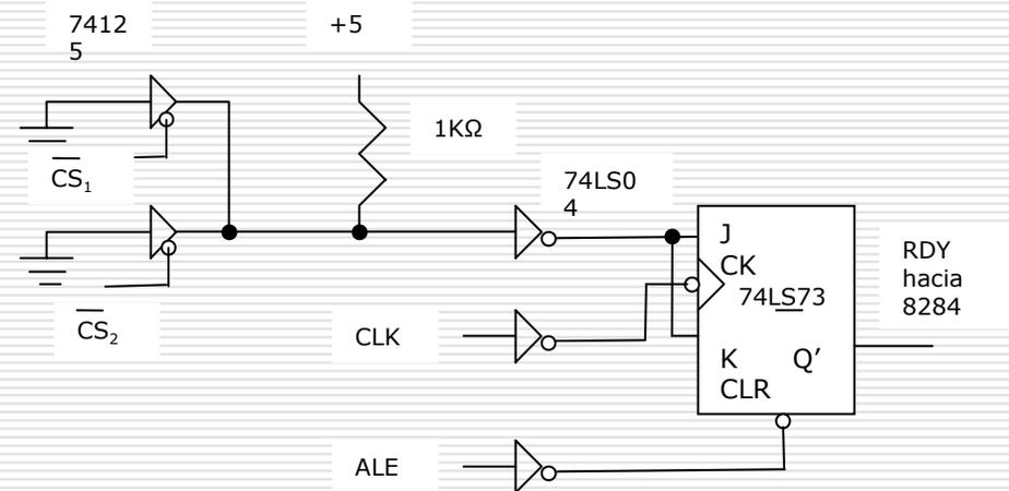
Figura. Generador de un Estado de Espera
