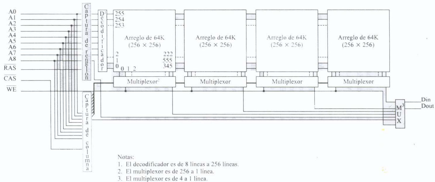
FIGURA 8-34 La estructura interna de una DRAM de 256K x 1. Se verá que cada una de las 256 palabras internas tiene 1025 bits de ancho.
